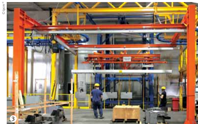
Figura 3: La zona di carico dei manufatti con il trasportatore birotaia e i discensori di Futura Convogliatori.
