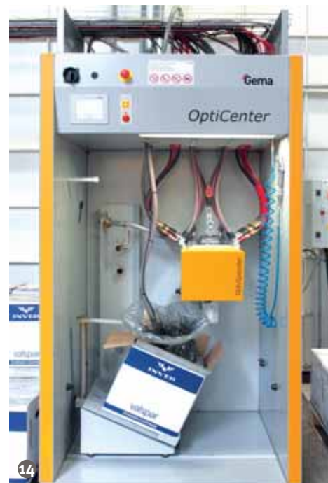
Figura 14: Il centro polveri OptiCenter di Gema Europe con le polveri fornite da Inver-Valspar.
