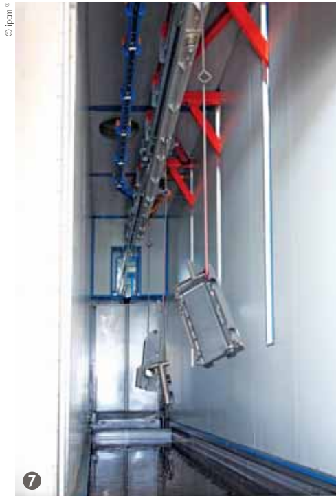
Figura 7: La prima fase di pretrattamento consiste in uno sgrassaggio alcalino ad immersione.
